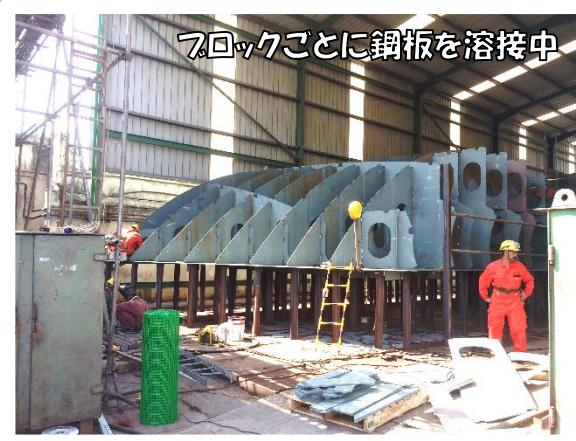
船はいくつものブロックに分けられ、別々に組み立てられます。ブロックが完成したら、建造ドックに移しブロック同士を組み立てていきます。
